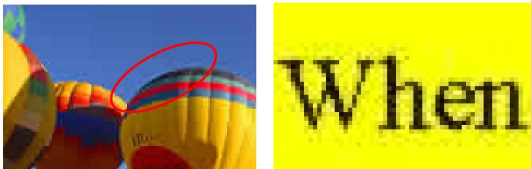
(a) À la transition entre la montgolfière et le ciel bleu, l'élimination des hautes fréquences produit un phénomène de *ringing*, d'oscillations caractéristiques d'un filtre passe-bas.
