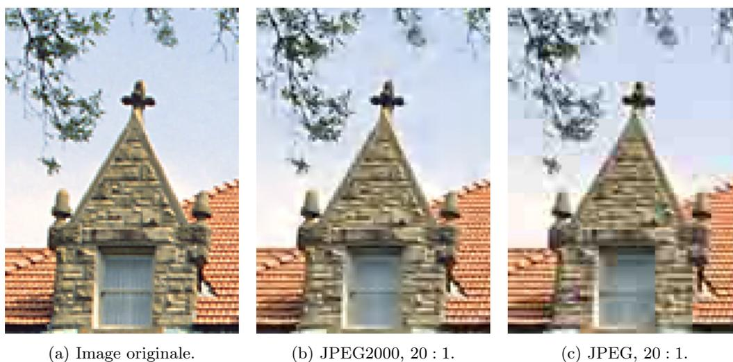
FIGURE 3.12 – Comparaison de deux “générations” de l'algorithme de compression JPEG, avec dans les deux cas un ratio de compression de 20 : 1. L'algorithme JPEG2000 se veut le successeur du standard JPEG : à la simpliste transformée de Fourier par blocs a été substituée une transformée en ondelettes multi-échelle, qui élimine les artefacts de “blocking” et offre de nombreux avantages pratiques. Images tirées du site [www.photozone.de](http://www.photozone.de).
